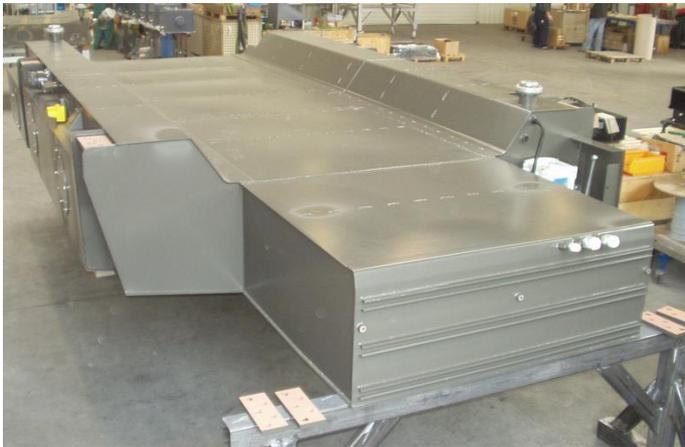
7000 Liter Kraftstoffbehälter; einbaufertig
